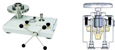
液体润滑活塞式压力计 液体润滑活塞式压力计的活塞系统结构图
