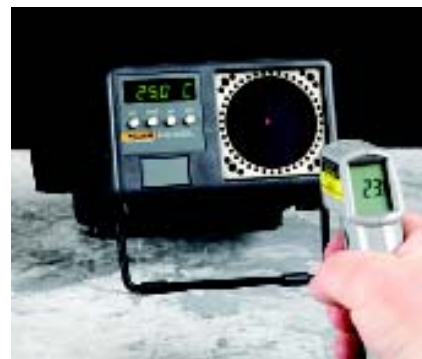
大尺寸目标靶可校准各类红外温度计
