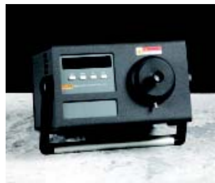
9133 含一个安装在仪器前部、可拆卸的盖子，可连接干燥空气进行吹洗，防止目标靶结冰
