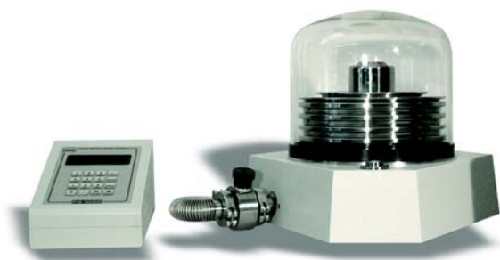
气体 4kPa ~ 7MPa, 真空参考 最优不确定度: 13ppm
