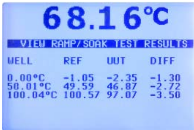
现场计量炉的“过程 914X-P”版本可保存多达 20 项不同的测试。
