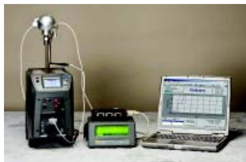
计量炉 914X, 数字温度计 1529, PRT 以及软件构成的现场温度计量系统
