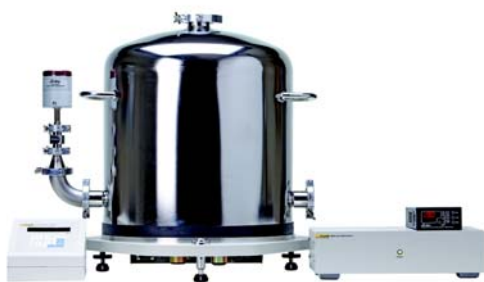
气体：表压/绝压 11kPa ~ 500kPa, PG9607; 表压 13kPa ~ 10MPa, PG9602
